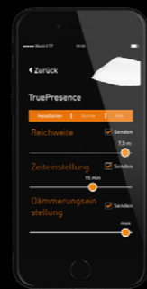
Высота монтажа 2 - 12 м True Presence®-Bereich Ø 9 м / 64 м² Диапазон Ø 15 м / 177 м²
