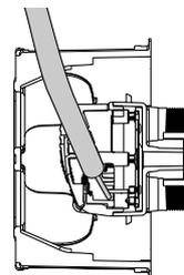
При подключении сзади минимизируется деформирование коаксиального кабеля, что позволяет избежать неоднородности его сопротивления и сохранить рабочие характеристики.
