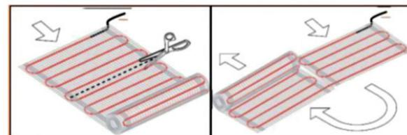
Для зон, которые не будут соответствовать полной ширине мата – 500 мм, кабель может быть удален из рогажки и прикреплён к полу с помощью клейкой ленты крепления. Рогажка может быть дополнительно прикреплена к полу с помощью клеящего пистолета, степлера или клейкой ленты.
